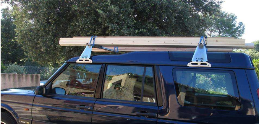
Sur Discovery 2, découpe de garniture de gouttière sur 250mm (Largeur barre)
