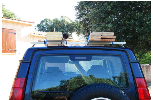
Sur Discovery 2, découpe de garniture de gouttière sur 250mm (Largeur barre)
